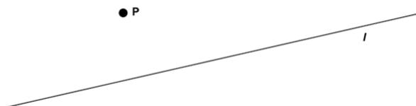
Solución. Esta vez lo haremos con el compás. Con centro en  $P$  y cualquier abertura trazamos dos arcos que corten a la recta  $l$  en dos puntos  $A$  y  $B$  como se muestra a continuación.
