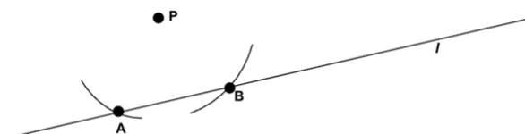
Ahora, con la misma abertura del compás (o con una distinta) nos apoyamos en  $A$  y trazamos un arco hacia el otro lado de  $l$  y lo mismo apoyados en  $B$ , para obtener lo siguiente:
