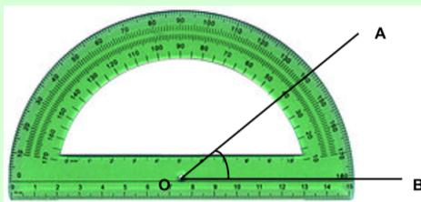
Como el ángulo abre de derecha a izquierda, nos fijaremos en los números de abajo ya que en estos el cero está a la derecha y la numeración va precisamente de derecha a izquierda, igual que el ángulo. Así que vemos que la medida del ángulo  $\angle AOB$  es de **40 grados** ó sea  $\angle AOB = 40^\circ$ .
