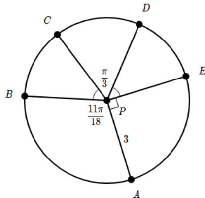
Si el haz de luz entra por  $D$  y sale por  $C$  en sentido dextrógiro. Si el radio del sincrotrón es de  $3\text{m}$  y el ángulo entre  $D$  y  $C$  es de  $\pi/3$ , determinar la longitud de la trayectoria que recorre el haz de luz de  $D$  a  $C$ .
